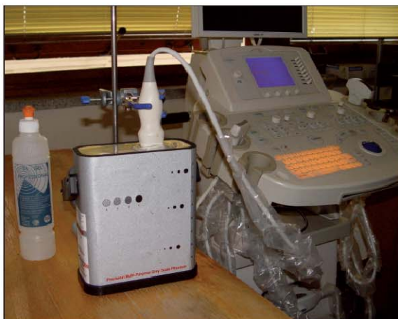
■ Měření kvalitativních parametrů sonografu s využitím standardního testovacího objektu Gammex RMI 403. | Foto: LF UP Olomouc
