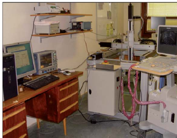
■ Pracoviště 3D měřící vanou při stanovení vyzařované intenzity sonografického přístroje s pomocí membránového hydrofonu. | Foto: LF UP Olomouc
